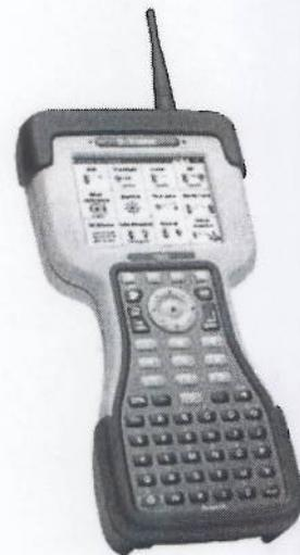
una radio integrada opcional de 2.4 GHz para un manejo sin cables cuando trabaja con una estación total robótica.
