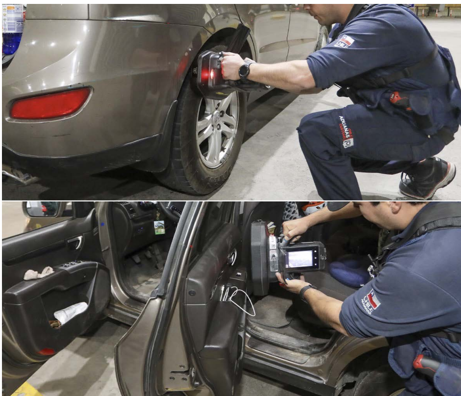
Trabajo de fiscalización de un vehículo con espectrómetro de masa en paso fronterizo Los Libertadores
